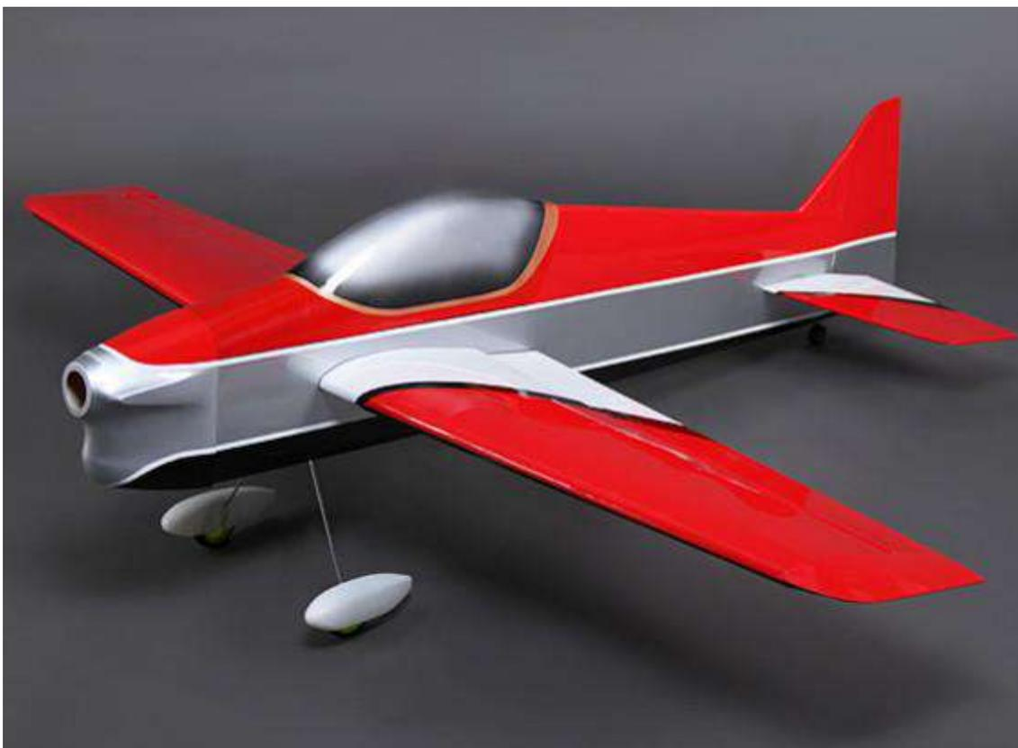
**Figura 42: modelo de acrobacia (F3A), com as características para o máximo de manobrabilidade como asa média e sem diedro, perfil com pouca curvatura ou mesmo simétrico para bom desempenho em voo invertido, superfície vertical (fuselagem e epenagem vertical) de grande dimensão para o voo “em faca” e superfícies de comando de grande dimensão para excelente controlabilidade a baixa velocidade.**
