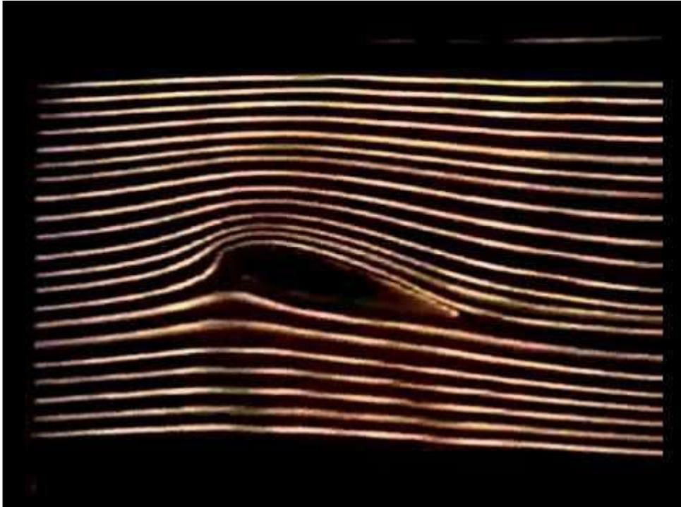
**Figura 8: perfil alar em túnel de vento**
