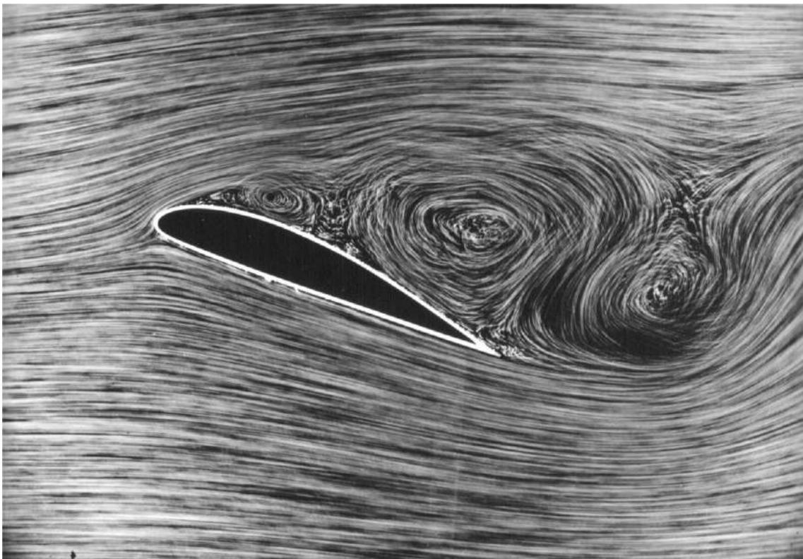
**Figura 19: fotografia em túnel aerodinâmico de uma secção de asa em perda.**
