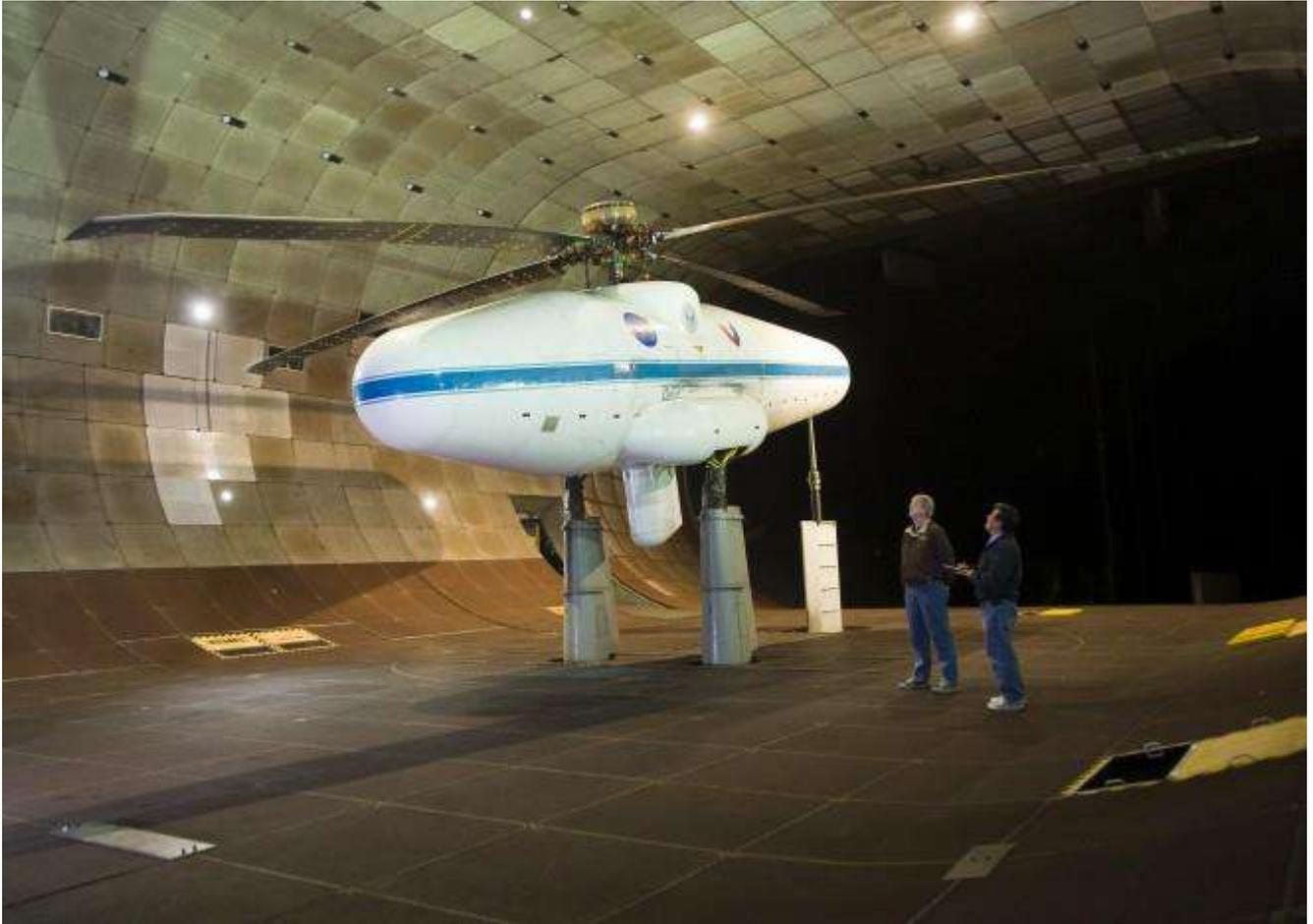
**Figura 2: o maior túnel aerodinâmico da actualidade com uma secção de 24,3m x 36,5m é o NASA Ames Research Center nos EUA, aqui utilizado para estudos de redução do ruído do rotor de um helicóptero.**
